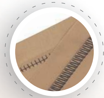
2-Draads flatlock breed Rekbare naad voor elastische stoffen
