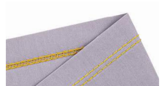
Coversteek, smal (3 mm) voor het omzomen, voor biesjes naaien, voor siereffecten
